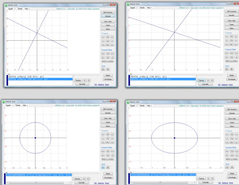
Qui a fianco vedete la stessa circonferenza di equazione  $x^2+y^2=1$  in un sistema monometrico e in un sistema dimetrico (in cui appare come un'ellisse).
