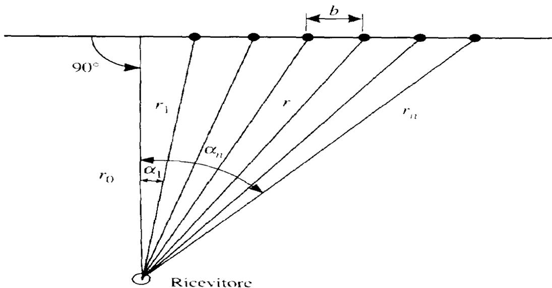
Facciamo anche l'ipotesi che tutte le sorgenti abbiano la stessa potenza, ma che ciascuna irradia suoni differenti. Allora, trascurando l'assorbimento dell'aria, la relazione da utilizzare per il calcolo del livello di pressione  $L_P$  in corrispondenza del ricevitore è la seguente (senza dimostrazione):
