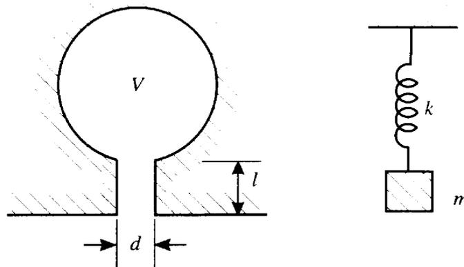
Questo dispositivo è in grado di dissipare energia acustica per attrito in corrispondenza della sua frequenza di risonanza: infatti, il suono incidente fa vibrare l'aria contenuta nel collo del risonatore, che si comporta come una massa vibrante collegata ad una molla (costituita dall'aria contenuta nella cavità).
