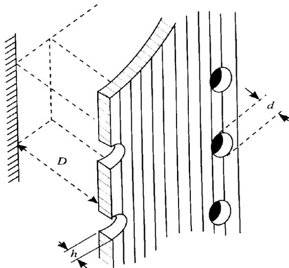
I risultati teorici e sperimentali mostrano che *i pannelli forati risonanti assorbenti possono essere utilmente impiegati nell'assorbimento delle medie frequenze acustiche*: in questo campo di frequenze, agendo sullo spessore del pannello, sulle dimensioni dei fori, sulla percentuale di foratura e sulla distanza di montaggio dalla parete, si può rendere massimo l'assorbimento nella banda di frequenze desiderata.
