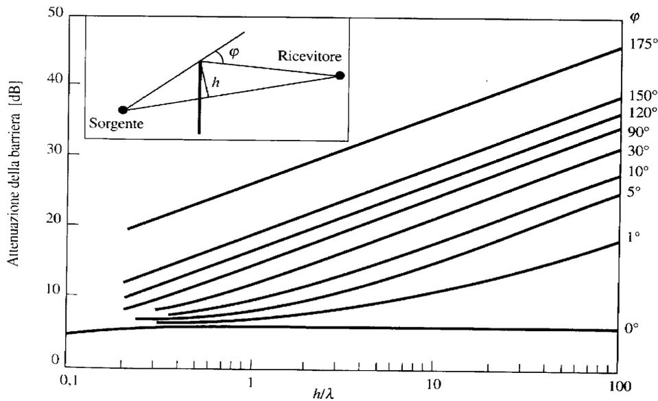
E' bene precisare che, comunque, i risultati forniti da tale diagramma sono approssimati, in conseguenza del fatto che si usano solo due parametri ( $h/\lambda$  e  $\varphi$ ) quando invece la teoria della diffrazione ne richiede rigorosamente 5.
