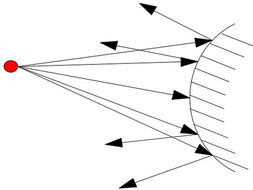
E' bene precisare che l'acustica geometrica, ipotizzando la propagazione dei suoni per raggi rettilinei, può essere applicata solo quando la lunghezza d'onda del suono è piccola in confronto con le dimensioni dell'ambiente, delle aperture e degli oggetti in esso contenuti.
