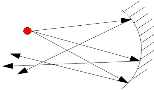
Se, invece, le superfici riflettenti sono **convesse**, allora si ottiene una dispersione dei raggi riflessi con il risultato di una migliore diffusione del suono nell'ambiente:
