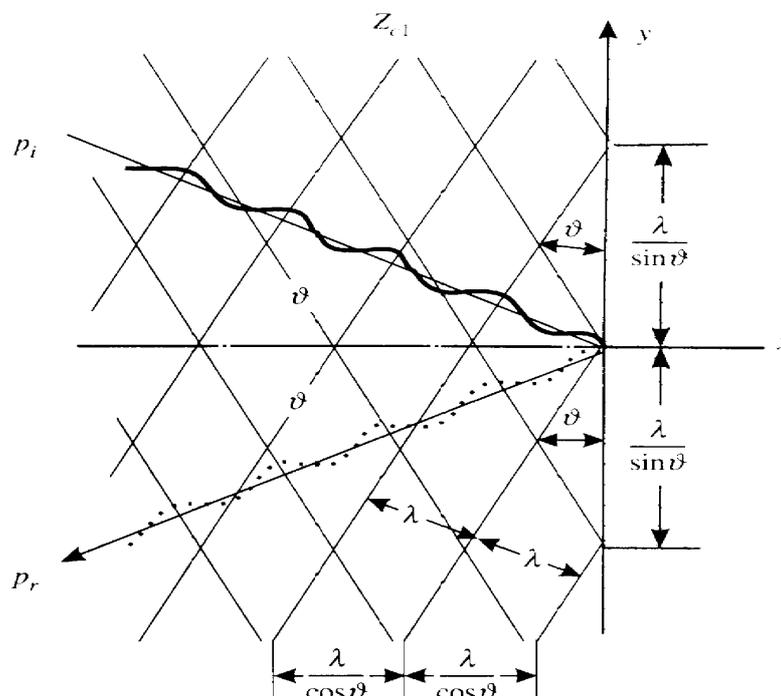
In questo caso, è possibile esprimere il coefficiente di assorbimento acustico (che indichiamo adesso con  $\alpha_\theta$  in modo da indicare l'angolo di incidenza) in funzione di un parametro caratteristico che prende il nome di **impedenza acustica di parete** (simbolo:  $Z_{W\theta}$ ), legato alle caratteristiche
