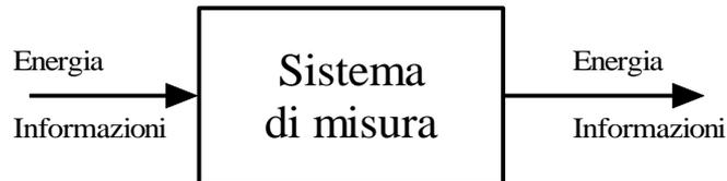
Il legame (generalmente espresso come rapporto) tra le quantità di uscita e di ingresso è la cosiddetta **caratteristica di trasferimento** dello strumento. Essa fornisce informazioni solo sul **comportamento statico** dello strumento, ossia sul comportamento in condizioni di funzionamento normale, quando il misurando subisce variazioni molto lente ed in assenza di urti, vibrazioni o accelerazioni.
