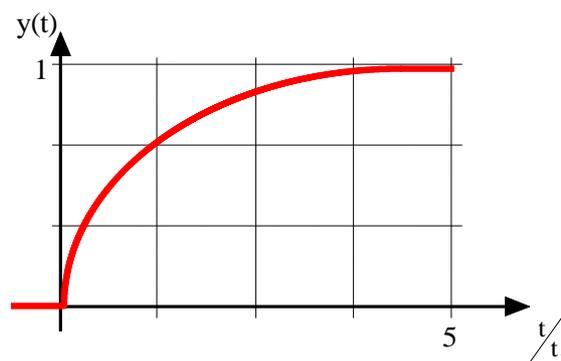
Quando  $t=t_1$ , la risposta assume un valore pari al 63.2% del valore finale di regime, che si raggiunge approssimativamente dopo  $5 t_1$ ; per  $t=2 t_1$ , il valore è pari all'86.5% del valore finale, mentre per  $t=3 t_1$  si passa al 95% .
