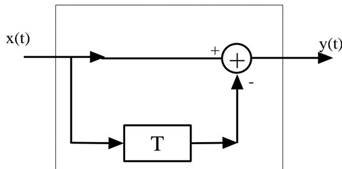
Abbiamo in precedenza già visto che questo è un sistema lineare tempo-invariante: l'espressione analitica dell'uscita in corrispondenza del generico  $x(t)$  è
