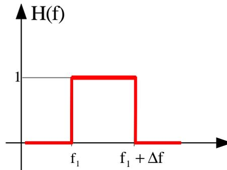
L'effetto di questo sistema sull'ingresso  $x(t)$  è dunque quello di lasciar passare, inalterata, solo quella parte di segnale compresa nell'intervallo di frequenza  $[f_1, f_1 + \Delta f]$ .
