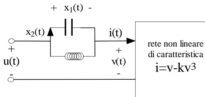
Questo circuito può essere facilmente modellato mediante un sistema tempo-continuo, tempo-invariante, del 2° ordine, la cui equazione (differenziale vettoriale) di stato sia
