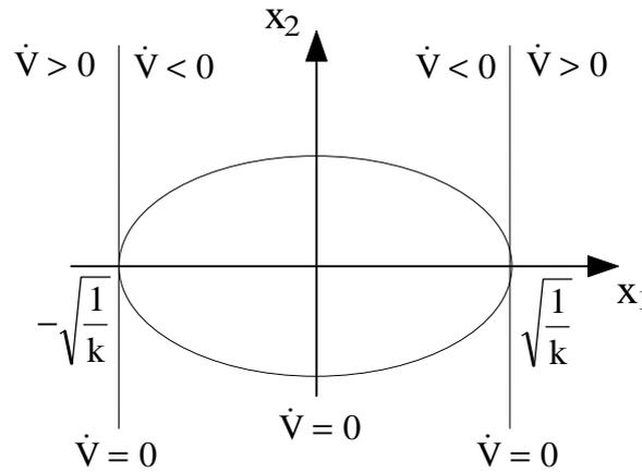
Le curve di livello della funzione  $V$  (cioè le intersezioni di questa funzione con piani paralleli al piano di stato) sono delle ellissi aventi centro nell'origine: allora, la più grande linea di livello all'interno della quale sono verificate le condizioni del primo teorema è quella tangente alle rette  $x_1 = \mp\sqrt{\frac{1}{k}}$ : **infatti, ....?**
