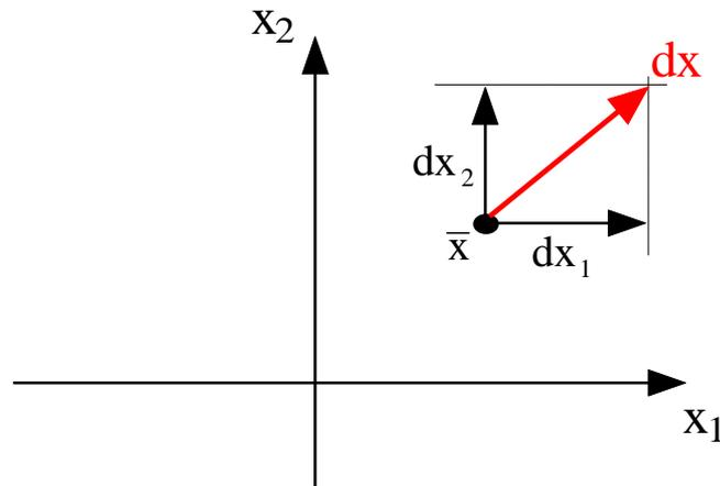
Allora, il rapporto  $\text{tg}\Psi = \frac{f_2(\bar{x})}{f_1(\bar{x})}$  rappresenta il coefficiente angolare della retta su cui giace lo spostamento infinitesimo  $dx$  tangente alla traiettoria del sistema nello stato  $\bar{x}$  considerato.
