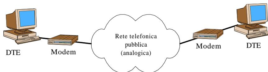
*Collegamento di due DTE tramite rete telefonica pubblica tradizionale (che cioè usa solo canali fonici). L'interfaccia tra il DTE e la rete è costituita dal **modem** (in generale dal DCE)*
