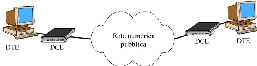
*Collegamento di due DTE tramite rete numerica pubblica (ad esempio ISDN):
