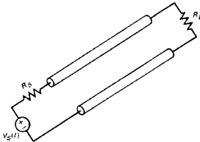
Ci serve un modello elettrico (a parametri distribuiti) di questa struttura. Possiamo considerare il seguente, relativo ad una linea di trasmissione di lunghezza  $L$ :
