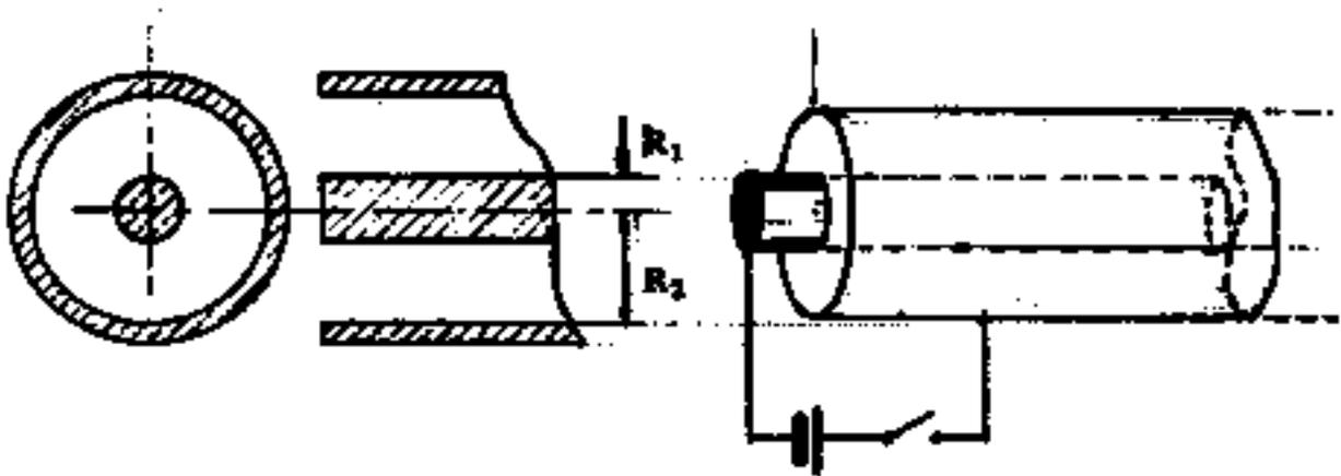
Abbiamo dunque sostanzialmente un sistema formato da due conduttori cilindrici coassiali, di raggio  $R_1$  ed  $R_2$ : il conduttore più esterno prende il nome di **calza** (o semplicemente *schermo*), mentre il conduttore interno viene detto **anima** del cavo. Le onde si propagano nello spazio interno
