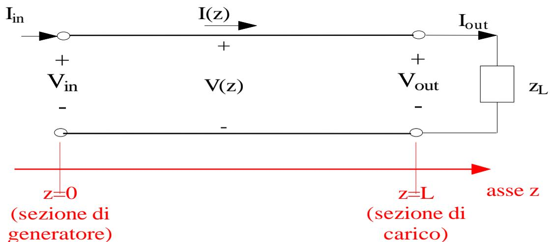
Le grandezze che caratterizzano questo tipo di struttura sono solitamente l'**impedenza caratteristica**  $z_c$  e la **velocità di propagazione**  $v$  delle onde lungo la linea.
