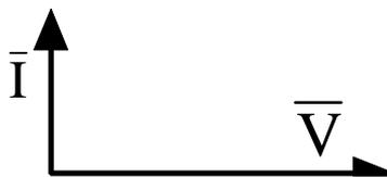
In questo caso, possiamo esprimere l’ “anticipo” della corrente rispetto alla tensione dicendo che, *preso il fasore associato alla tensione, quello associato alla corrente deve ruotare di  $90^\circ$  in senso orario per sovrapporsi ad esso.*
