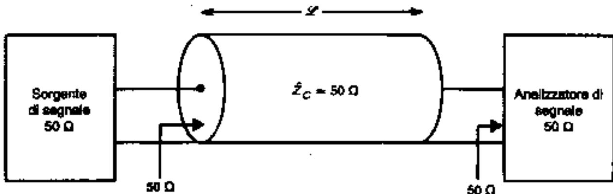
Abbiamo qui una sorgente di segnale, con resistenza interna di  $50 \Omega$ , connessa ad un analizzatore di segnale (con resistenza di ingresso ancora da  $50 \Omega$ ) tramite un cavo coassiale di impedenza caratteristica  $z_c=50\Omega$  <sup>(1)</sup>.
