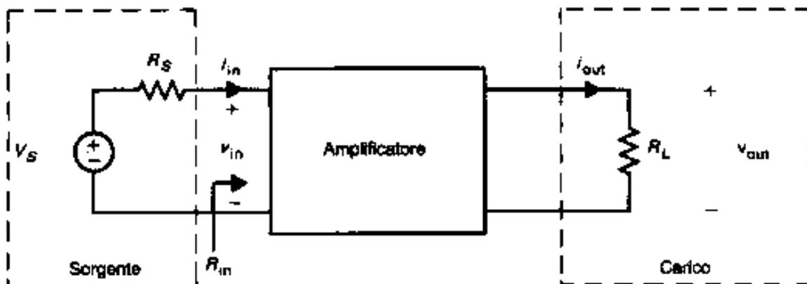
La **sorgente** di segnale è caratterizzata da una **tensione a vuoto**  $V_S$  e da una **resistenza interna**  $R_S$ ; essa fornisce il segnale ad un **amplificatore** il cui **carico** è rappresentato dalla resistenza  $R_L$ .
