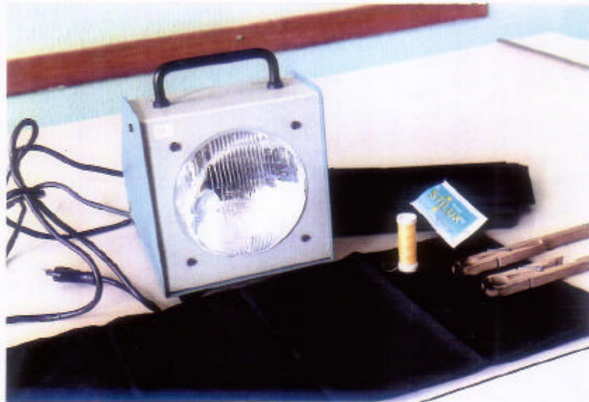
FIGURA 7: STROBOSCOPIO, PANNINO NERO, FILO, STAR-LIGHT
