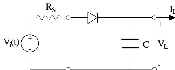
Supponiamo inoltre che la resistenza  $R_S$  includa anche l'eventuale resistenza del diodo quando è in fase di conduzione; in tal modo, il diodo presente nel circuito risulta avere adesso una caratteristica statica del tipo seguente:
