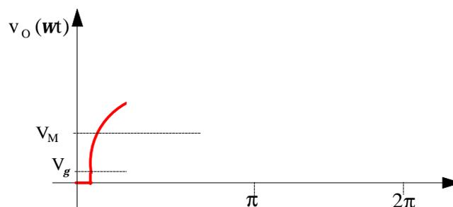
Quindi, mentre il diodo è in conduzione (a tensione approssimativamente costante e pari a  $V_\gamma$ ), la situazione è del tutto analoga a quella esaminata quando mancava il condensatore; la differenza, le cui conseguenze saranno chiare tra un attimo, è nel fatto che è partito un processo di **carica** del condensatore stesso.
