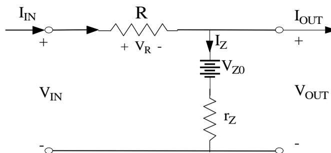
Calcoliamo allora la tensione di uscita applicando la sovrapposizione degli effetti: gli ingressi, in questo circuito, sono  $V_{IN}$ ,  $V_{z0}$  e  $I_{OUT}$ , per cui otteniamo che
