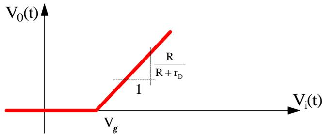
La cosa interessante da notare riguarda la pendenza del tratto di curva obliquo: tale pendenza vale  $\frac{R}{R+r_D}$  ed è abbastanza prossima ad 1 (cioè l'inclinazione è di  $45^\circ$ ), visto che la resistenza del diodo, in conduzione, è generalmente molto bassa rispetto ad  $R$ . Di conseguenza, la retta è inclinata a circa  $45^\circ$ , il che significa che, per  $V_i > V_g$ , la tensione di uscita riproduce esattamente o quasi la tensione in ingresso.
