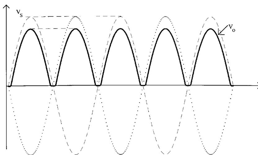
Il vantaggio, come detto, sta sia nella possibilità di utilizzare un *trasformatore tradizionale* sia, anche, nel fatto che la tensione inversa massima ai capi di ciascun diodo non supera adesso il valore  $V_M$ .
