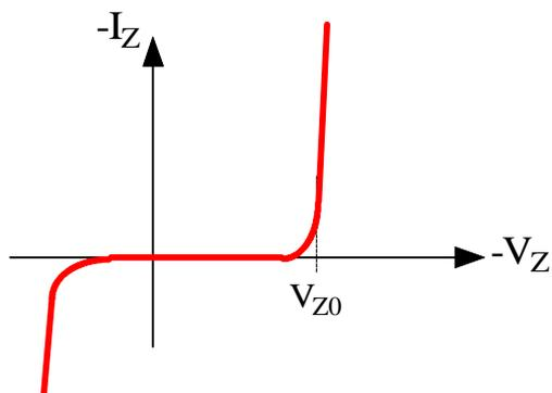
La tensione  $V_{z0}$  è la tensione di breakdown (negativa) del diodo: si osserva, rispetto ad un diodo tradizionale in diretta, sia la presenza di un *ginocchio di corrente* più marcato in corrispondenza della tensione di rottura sia una resistenza di conduzione più bassa.
