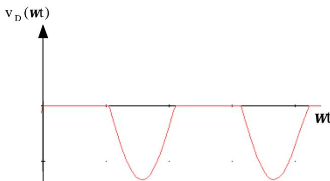
Questo grafico andrebbe in realtà perfezionato tenendo conto che, quando la  $V_{IN}(t)$  è positiva, la  $v_D(t)$  si assesta sul valore  $V_\gamma$  ed anche che sul diodo c'è una certa caduta di tensione.
