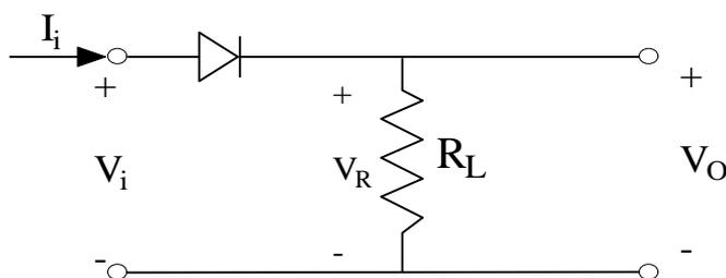
Supponiamo che la tensione in ingresso sia una forma d'onda sinusoidale del tipo  $v_i(t) = V_M \sin(\omega t)$ , dove ovviamente  $\omega = 2\pi f$  è la pulsazione angolare dell'onda e  $f$  la frequenza (che porremo nei calcoli uguale a 50Hz).
