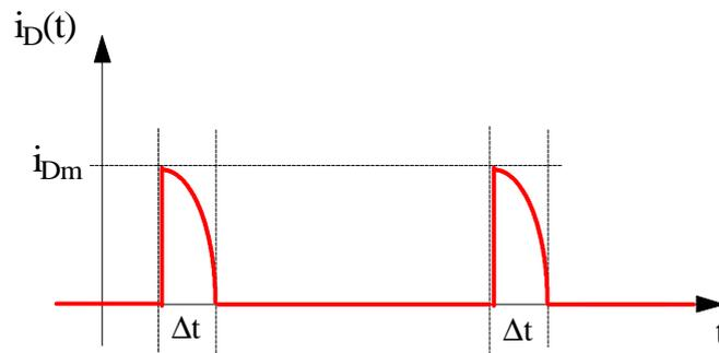
Come detto, questi impulsi sono fatti in modo tale che l'area da essi sottesi corrisponda esattamente alla carica persa durante l'ultima scarica del condensatore. Possiamo allora applicare proprio il **principio di conservazione della carica** per ricavare il valore di  $i_{Dm}$ , ossia appunto la massima corrente che fluisce nel diodo.
