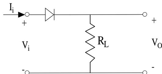
Si osserva immediatamente che *il circuito riportato è identico ad un circuito limitatore di tensione, con la differenza, però, che la tensione di uscita è in questo caso prelevata ai capi del resistore e non più ai capi del diodo.*
