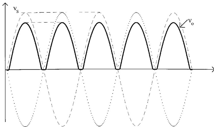
Ponendo allora il solito condensatore in parallelo al carico, è chiaro che riduciamo (per la precisione dimezziamo) l'intervallo di tempo a disposizione per la scarica del condensatore: questo comporta la perdita di una minore quantità di
