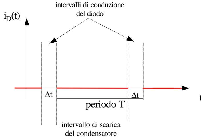
Nei due intervalli indicati in figura, il diodo è in conduzione: da un punto di vista fisico, la conduzione del diodo è determinata dal fatto che, durante questi intervalli, il diodo deve rifornire il circuito di quella carica che si è persa durante l'ultima scarica del condensatore.
