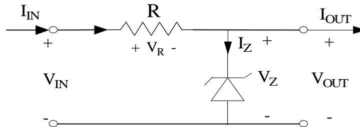
A ben guardare, si tratta di un circuito abbastanza simile ad un limitatore di tensione; la differenza sta nel fatto che il diodo utilizzato è un **diodo Zener** ed è posto con le polarità invertite rispetto a quanto si fa nei limitatori. Questo, come vedremo adesso, consente di sfruttare le prestazioni del diodo Zener quando lavora in breakdown.
