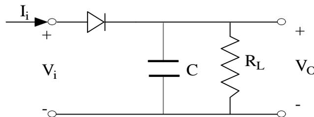
E' subito intuitivo aspettarsi che questo condensatore modifichi profondamente il comportamento del circuito visto prima: infatti, esso introduce nel circuito una **costante di tempo**, determinando così un comportamento dinamico radicalmente diverso dal *comportamento statico* esaminato fino ad ora.
