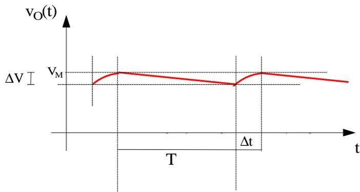
Essa è caratterizzata, tra le altre cose, dal fatto che la tensione  $v_L(t)$  segue la tensione in ingresso fino a quando essa raggiunge il picco  $V_M$  e poi, durante l'intervallo di scarica del condensatore (che corrisponde al periodo di tempo in cui il diodo non conduce), scende dal valore  $V_M$  al valore  $V_M - \Delta V$ .
