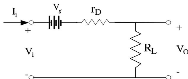
Da questo circuito, applicando per esempio la sovrapposizione degli effetti (cioè considerando prima  $V_\gamma=0$  e poi  $V_i=0$ ), è immediato ricavare che la tensione in uscita vale
