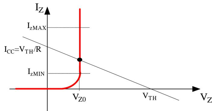
Adesso possiamo imporre le specifiche sul diodo Zener. Infatti, è chiaro che la retta di cui abbiamo poco fa individuato l'equazione varia al variare di  $V_{TH}$  (e cioè di  $V_C$ ) e di  $R$ : allora, dobbiamo determinare i valori di  $V_C$  e di  $R$  in modo tale che la corrente nel diodo soddisfi la condizione  $I_{zMIN} \leq I_Z \leq I_{zMAX}$ .
