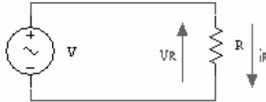
Nel circuito puramente resistivo la corrente è in fase con la tensione (il resistore non sfasa le sinusoidi di corrente e tensione).
