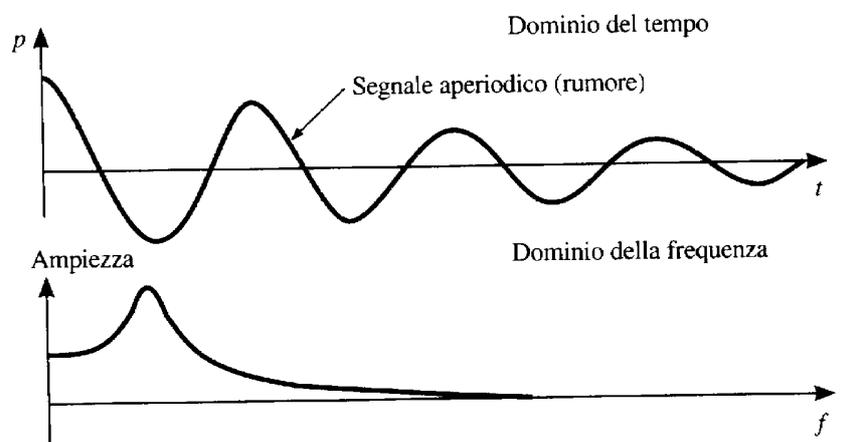
In questo caso, esso può essere scomposto in una somma di infiniti termini armonici, tali però che la differenza di frequenza di due termini successivi non sia discreta, ma infinitesima. Questo fa sì che l'insieme delle frequenze dei termini componenti vada a costituire una distribuzione non più discreta, ma continua, ossia uno **spettro continuo** come quello indicato in figura nel secondo diagramma<sup>1</sup>.
