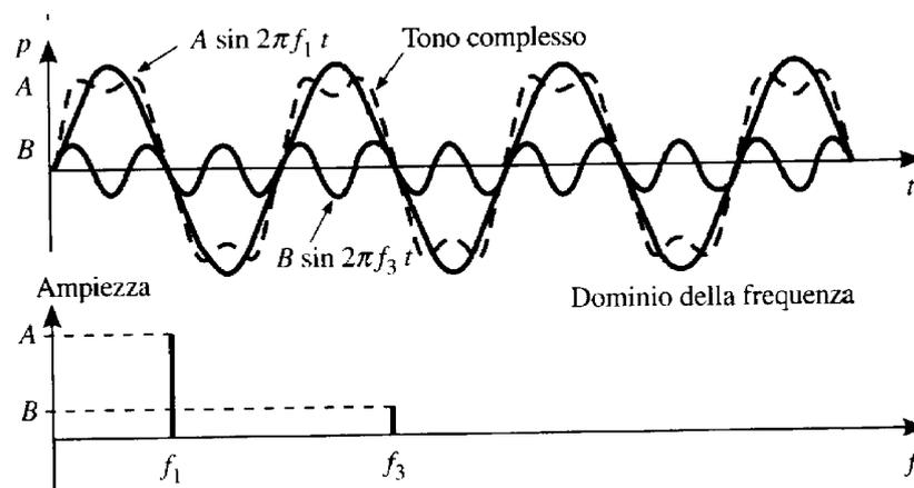
In questo caso, abbiamo la sovrapposizione di più suoni puri, ciascuno a diversa frequenza, per cui lo spettro sonoro è formato da più linee in corrispondenza delle frequenze multiple che compongono il suono originario (nella figura sono 2 per semplicità).
