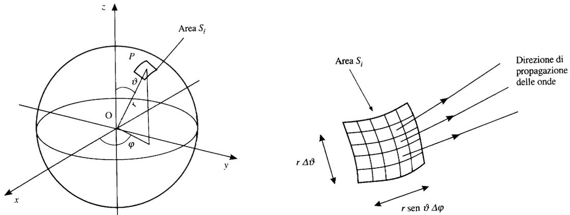
In pratica, si suddivide la superficie chiusa  $S$  in  $N$  elementi di superficie  $S_k$ ; in corrispondenza di ciascun elementino, si determina l'intensità sonora  $I_k$ ; con queste informazioni, la potenza acustica della sorgente nelle varie bande di frequenza si ottiene mediante la seguente relazione:
