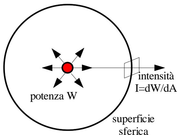
Consideriamo dunque la superficie infinitesima (di area  $dA$ ) orientata normalmente rispetto alla direzione di propagazione dell'onda; supponiamo che tale superficie intercetti la porzione  $dW$  di potenza (= energia nell'unità di tempo) emessa dalla sorgente: in tal modo, l'**intensità acustica** è definibile mediante la relazione
