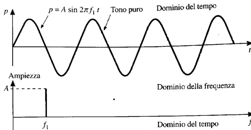
Un suono puro (detto anche **tono puro**) è un segnale sinusoidale caratterizzato da una ben precisa frequenza: di conseguenza, il suo spettro sonoro è costituito semplicemente da una sola linea in corrispondenza di tale frequenza.
