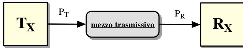
Indichiamo con  $P_T$  la **potenza trasmessa** dal trasmettitore (cioè quella inviata sul mezzo trasmissivo) e con  $P_R$  la **potenza ricevuta** dal ricevitore (ossia quella in uscita dal mezzo trasmissivo).
