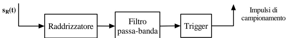
In realtà, c'è un problema da affrontare: non è garantito che la suddetta relazione di fase sia tale da far combaciare perfettamente gli impulsi di campionamento con i massimi delle forme d'onda in uscita dal filtro. Il motivo è che il segnale ed i sincronismi percorrono strade diverse, per cui è *necessario prevedere necessariamente uno sfasamento temporale tra le forme d'onda di comando e quelle in uscita dal filtro di ricezione.*
