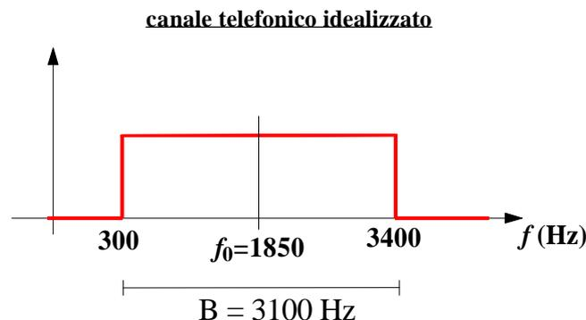
Vogliamo effettuare una trasmissione numerica, su questo mezzo trasmissivo, del segnale telefonico e vogliamo dimensionare il sistema in modo da ottenere una probabilità di errore  $p(\epsilon) = 10^{-9}$  (il che significa sbagliare 1 bit ogni miliardo).
