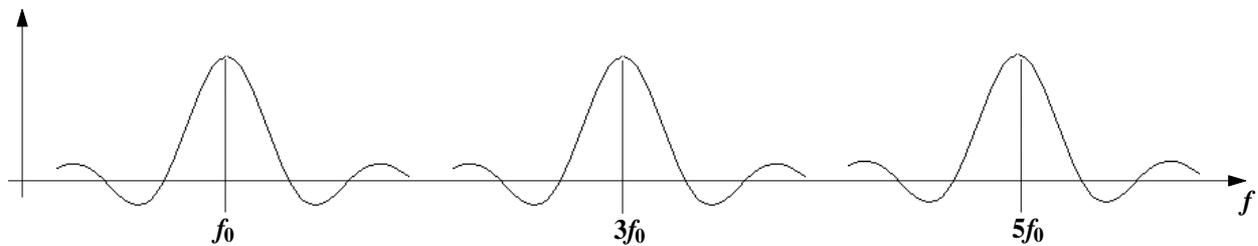
Anche in questo secondo caso si può ottenere in ricezione solo lo spettro del segnale di interesse: basta usare un filtro passa-banda centrato attorno alla frequenza  $f_0$  e di banda passante sufficiente: il risultato è proprio lo spettro  $\sin(f)/f$  centrato su  $f_0$ , ossia appunto la sinusoide a frequenza  $f_0$  modulata da un’onda rettangolare.
