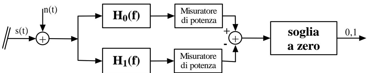
Il misuratore di potenza può essere semplicemente un demodulatore ad involuppo, in quanto ciò che interessa è il valore massimo del segnale in uscita dal filtro, in quanto tale valore determina la potenza di picco. Il suo schema circuitale sarà quindi del tipo seguente:
