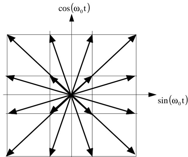
Nella figura è stato considerato un sistema costituito da 16 livelli equidistanti tra loro. Il modo con cui realizzare praticamente questo sistema è abbastanza semplice: *basta scegliere in modo opportuno le ampiezze dei due segnali modulanti, in modo da ottenere un sistema multilivello sia sulla fase, come nel caso M-PSK, sia anche sull'ampiezza.*
