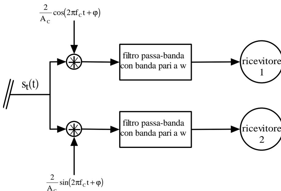
Anche l'apparato demodulatore consta di due rami, in ciascuno dei quali viene effettuata una demodulazione del segnale modulato  $s_t(t)$  secondo sempre la tecnica DSB-SC; in particolare, tale demodulazione consiste nella moltiplicazione di  $s_t(t)$  per il segnale  $\frac{2}{A_c} \cos(2\pi f_c t + \varphi)$  nel caso di  $s(t)$  e per il segnale  $\frac{2}{A_c} \sin(2\pi f_c t + \varphi)$  nel caso di  $g(t)$ , e nel successivo filtraggio.
