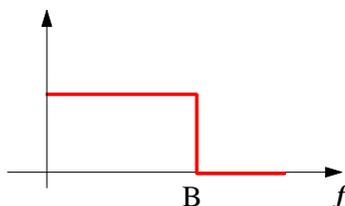
Vediamo adesso cosa succede se il mezzo trasmissivo è passa-banda (come l'atmosfera terrestre usata nei ponti radio terrestri e nei collegamenti via satellite), ossia lascia passare frequenze comprese in un certo intervallo B, simmetrico rispetto ad una *frequenza centrale*  $f_0$ :
