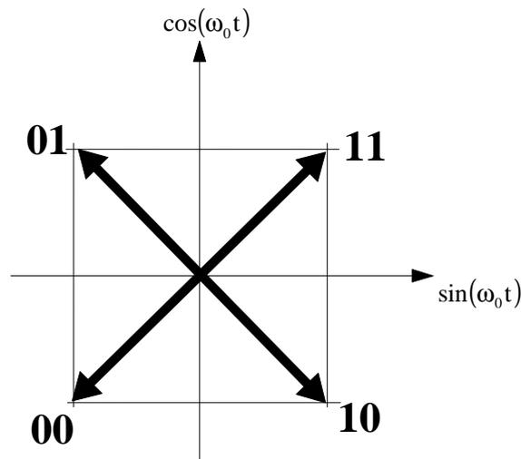
Scegliendo, dunque, l'ampiezza dei due segnali modulanti, possiamo trasmettere, sullo stesso canale, cioè occupando sempre la stessa banda (che sarà  $2B$ , se  $B$  è la banda del singolo segnale modulante), due simboli binari. Questo sistema consiste perciò in una **modulazione di fase a 4 livelli** (brevemente **4-PSK**).
