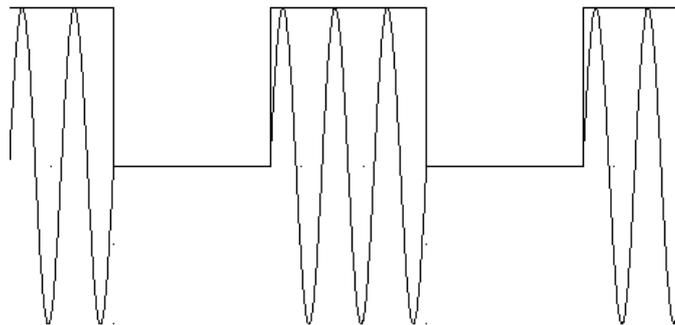
Nella figura è tracciato sia il segnale modulato (costituito da "pezzi" di sinusoidi) sia il segnale modulante, cioè la sequenza di rettangoli: la sequenza binaria considerata in questo caso è 10101.
