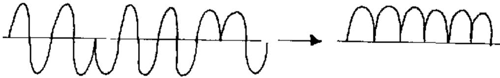
Questo segnale è periodico e quindi ha spettro a righe; inoltre, esso contiene notoriamente una componente a frequenza  $2f_0$ , che quindi possiamo tranquillamente estrarre mediante un successivo filtraggio passa-banda molto stretto.
