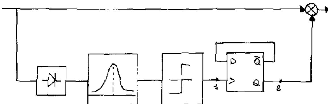
Così facendo, abbiamo ottenuto un segnale, sia pure non sinusoidale, alla frequenza  $f_0$  desiderata, ma non siamo certi di quale sia la fase, che può essere 0 oppure  $\pi$ <sup>13</sup>. Il fattore che determina l'una o l'altra fase è lo stato del circuito all'inizio di tutta procedura.
