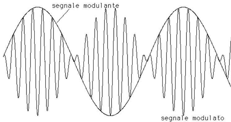
(si è utilizzata una sinusoide a frequenza evidentemente inferiore a quella della portante)
