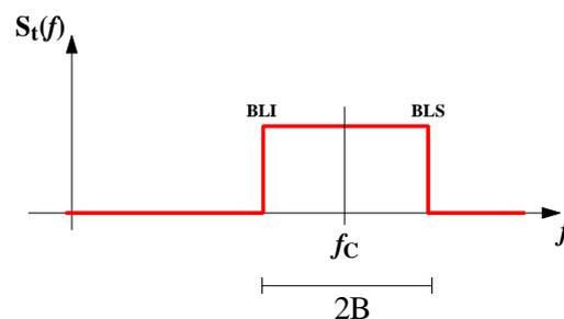
La frequenza di cifra, però, rimane  $2B$ , per cui continuiamo a trasmettere  $2B$  bit al secondo, ma occupando una banda doppia rispetto a prima. Quindi, rispetto alla trasmissione in banda base, la modulazione ASK comporta uno spreco di banda, quantificabile con un fattore 2.
