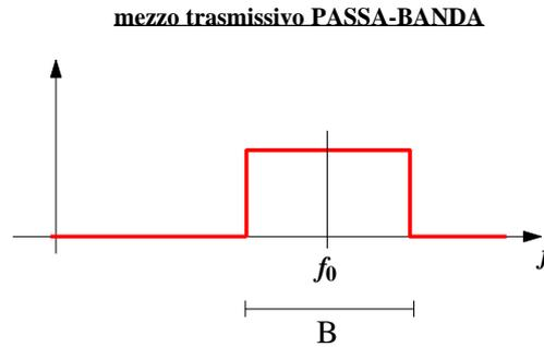
In questo caso, dobbiamo fare in modo che il segnale da trasmettere abbia tutte le proprie componenti spettrali comprese nell'intervallo  $\left[ f_0 - \frac{B}{2}, f_0 + \frac{B}{2} \right]$ . Per ottenere questo, è necessario effettuare una **modulazione**.
