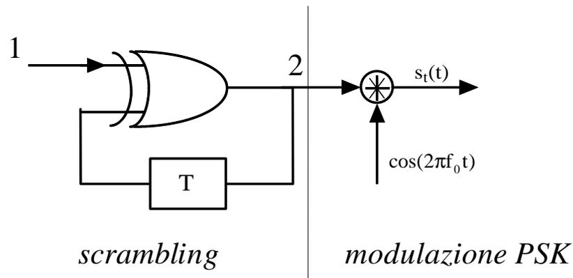
Abbiamo quindi effettuato uno **scrambling** della sequenza da trasmettere, dopo di che viene effettuata una normalissima modulazione PSK. Lo scrambling è tale da modificare la sequenza originale nel modo seguente: se il bit considerato è uguale al precedente, per cui non ci deve essere alcuna variazione di fase, lo scrambling fornisce uno 0, mentre invece, se è diverso dal precedente, per cui ci deve essere una variazione di fase di  $\pi$ , lo scrambling fornisce un 1.
