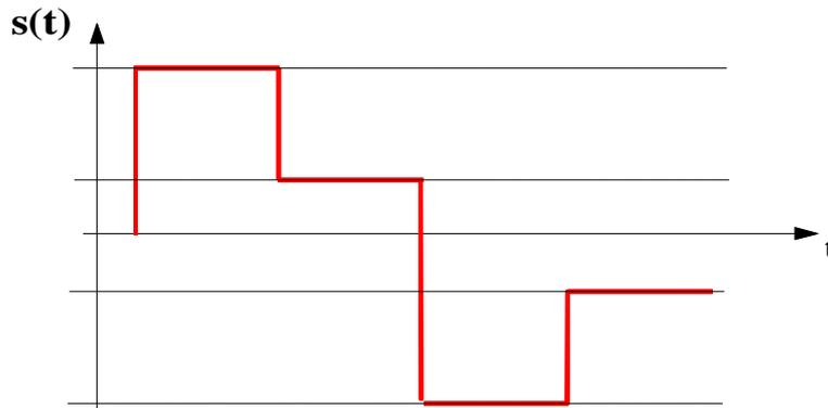
Usando questo segnale per modulare la portante sinusoidale, è chiaro che il segnale modulato non ha più inviluppo costante. Questo spiega il concetto precedentemente esposto, secondo cui il sistema M-QAM è un multilivello sia sulla fase (come l' M-PSK) sia sull'ampiezza.
