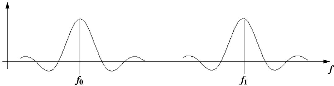
Allora, il ricevitore ottimo è costituito da due filtri, la cui risposta all'impulso somigli alle forme d'onda per le quali sono usati: il filtro relativo al simbolo 0 sarà un filtro passa-banda centrato alla frequenza  $f_0$ , mentre quello relativo al simbolo 1 sarà un filtro passa-banda centrato attorno a  $f_1$ .
