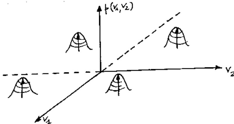
Data la perfetta simmetria e uguaglianza delle gaussiane e data, come al solito, l'equiprobabilità delle combinazioni<sup>9</sup>, il modo più sensato di procedere è quello di porre le soglie a metà tra una gaussiana e l'altra. Fissate le soglie, le singole probabilità di errore, da cui poi risalire alla probabilità di errore  $p(\epsilon)$  complessiva, corrispondono ai volumi occupati dalle code delle 4 gaussiane.
