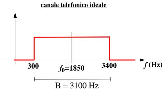
Supponiamo, per semplicità, che il canale sia perfettamente equalizzato (per cui il segnale in uscita ha attenuazione costante in banda), abbia caratteristiche costanti nel tempo e abbia caratteristica di fase rettilinea con la frequenza (il che significa che il *ritardo di gruppo* del canale è rigorosamente costante). Queste ipotesi individuano il cosiddetto **canale telefonico ideale**.
