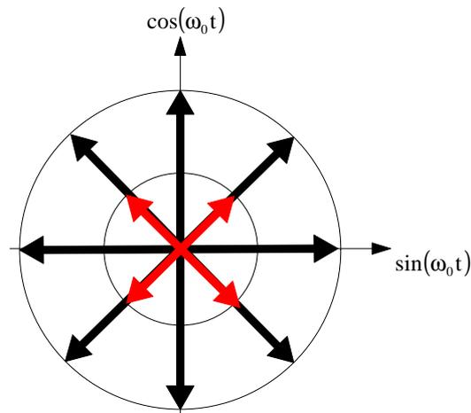
Nella figura sono indicati un sistema 4-PSK ed un sistema 8-PSK: la maggiore ampiezza dei vettori di quest'ultimo sistema fa sì che la distanza tra gli estremi dei vettori, cioè la distanza tra le gaussiane, sia la stessa che si ottiene con il 4PSK, usando una ampiezza minore. La probabilità di errore è la stessa nei due casi.
