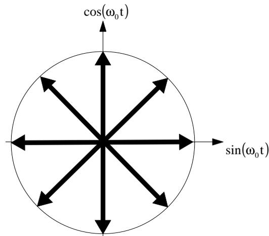
Infittendo ulteriormente il numero di livelli, è evidente che la probabilità di errore, a parità di ampiezza dei vettori, aumenta. Vediamo allora con maggiore dettaglio quello che succede.
