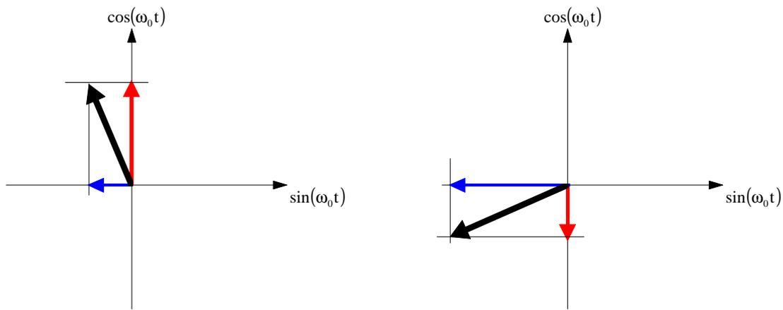
In realtà, le possibili situazioni diventano in numero finito qualora i segnali modulanti siano di tipo numerico, ossia rettangoli di due sole possibili ampiezze (ad esempio  $+a$  e  $-a$ ). In questo caso, infatti, le possibilità sono solo 4:
