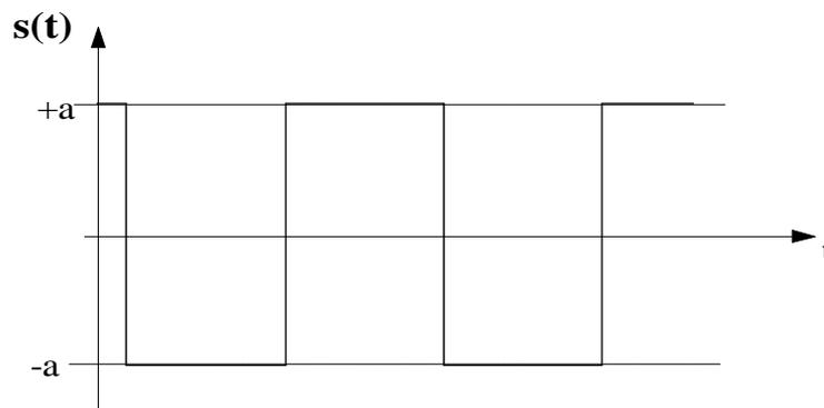
Questo segnale va a modulare (cioè moltiplica) la portante sinusoidale a frequenza prefissata  $f_0$ , dando origine ad una forma d'onda del tipo seguente:
