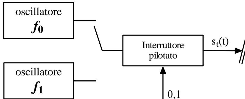
Il segnale modulante  $s(t)$  pilota quindi un commutatore che collega il canale a uno dei due oscillatori, scelto appunto in base al valore di  $s(t)$  in ogni istante.
