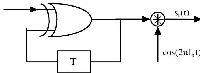
Il moltiplicatore riceve in ingresso la portante sinusoidale  $\cos(2\pi f_0 t)$  che deve moltiplicare per una forma d'onda rettangolare (sempre di durata  $T$ ); se il bit da inviare è uguale a quello trasmesso del periodo precedente, allora la forma d'onda usata per il bit precedente deve essere usata anche per il bit in esame; se, invece, il bit in esame è diverso dal precedente, allora il rettangolo usato nel periodo precedente va adesso complementato.
