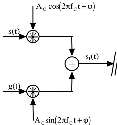
Lo scopo è di trasmettere, mediante lo stesso mezzo trasmissivo, due distinti segnali  $s(t)$  e  $g(t)$ : ciascuno modula d'ampiezza, mediante la tecnica DSB-SC, una portante a frequenza  $f_c$ , con la differenza che uno modula una portante Coseno e l'altro una portante Seno. I due segnali modulati vengono successivamente sommati per ottenere l'unico segnale da trasmettere attraverso il canale:
