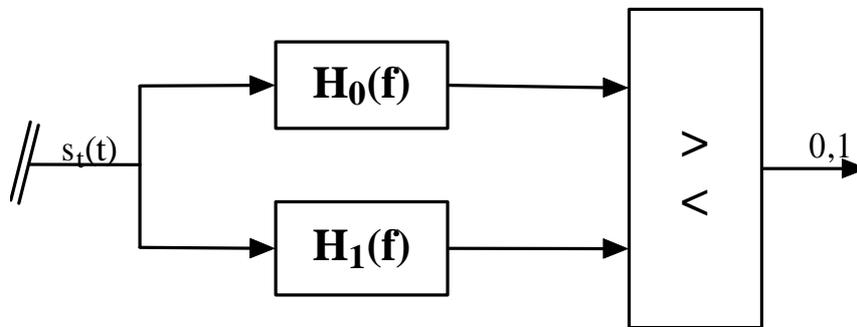
Come effettuare il confronto tra le due uscite? Se i due filtri sono adattati, le uscite, per ciascun simbolo trasmesso, sono qualcosa di proporzionale alla funzione di autocorrelazione di una sinusoide (a frequenza  $f_0$  o  $f_1$ ) di durata T. Il simbolo per cui decidere sarà allora quello corrispondente al filtro che in uscita produce un segnale di potenza di picco maggiore. Si può allora adottare un semplice schema del tipo seguente:
