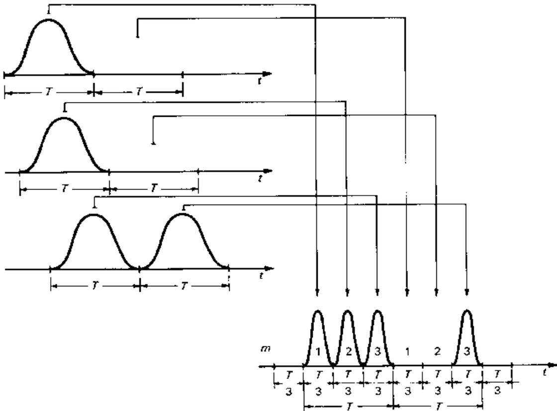
Il generico segnale numerico singolo di partenza è formato da impulsi di durata T: data l'azione del commutatore, nel segnale TDM il tempo riservato a ciascun impulso è diviso per N rispetto al tempo T, per cui ciascun impulso dura adesso un tempo  $T/N$ . Si è cioè ottenuto un nuovo segnale di tipo numerico, dove però il tempo di ripetizione degli impulsi è diventato  $T/N$ . La corrispondente banda occupata sarà allora N volte la banda del segnale di partenza, ossia appunto  $NB$ .
