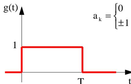
La scelta tra +1 e -1, quando c'è da trasmettere un 1 logico, va fatta in modo da garantire l'alternanza di segno. Facciamo un esempio concreto. Supponiamo che la sequenza binaria da trasmettere sia 101011101. Allora, la sequenza dei coefficienti sarà fatta nel modo seguente:
