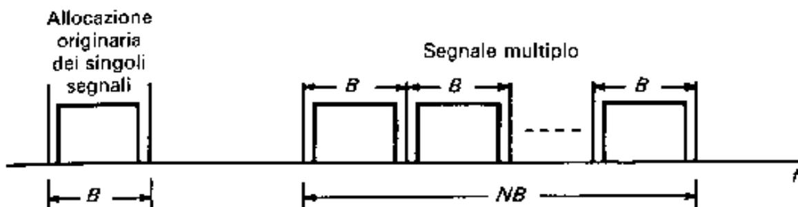
In ricezione, si dovranno predisporre N filtri (oppure un unico filtro sintonizzabile a seconda dei casi), ciascuno con banda B, che dovrà selezionare solo il segnale di interesse, eliminando gli altri.
