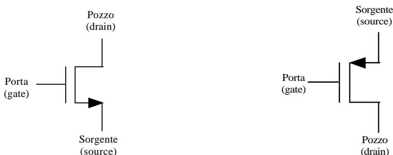
Esistono alcuni circuiti integrati realizzati nella cosiddetta **tecnologia complementare** (brevemente **CMOS**, che sta per *Complementary MOS*): essi sono caratterizzati dalla presenza contemporanea di NMOS e PMOS.
