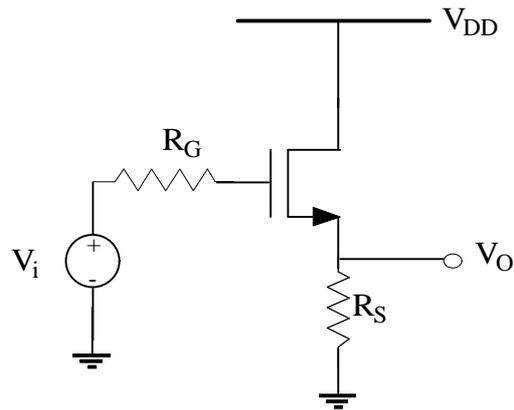
Dal punto di vista della connessione, è ovvio che non cambia niente rispetto al caso bipolare: infatti, la resistenza  $R_E$ , che costituisce sempre la rete di reazione, preleva la tensione di uscita  $v_O$  e la riporta così com'è in ingresso (cioè  $f=1$ ).
