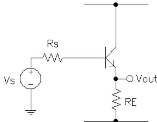
Come visto poco fa nel calcolo dei singoli parametri della rete di azione e di quella di reazione, gli effetti di carico esercitati dalla rete di reazione su quella di azione sono rappresentati dai parametri  $h_{11f}$  (ingresso) e  $h_{22f}$  (uscita):
