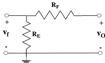
Vogliamo allora calcolare il modello a parametri h di questa rete di reazione. Applicando le definizioni, abbiamo quanto segue:
