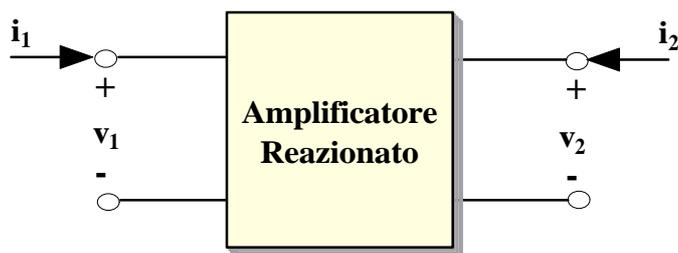
Le equazioni, assolutamente generiche, che descrivono il comportamento dell'amplificatore alle due porte sono diverse a seconda di come si scelgano le due variabili indipendenti. La tabella seguente mostra 4 delle 6 possibilità:
