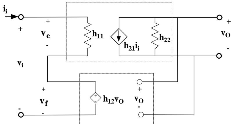
Si tratta di uno schema del tutto equivalente a quello ideale, ma i suoi parametri tengono questa volta in conto sia il trasferimento inverso della rete di reazione sia il trasferimento diretto della rete di azione sia gli effetti di carico esercitati dalla rete di reazione su quella di azione.
