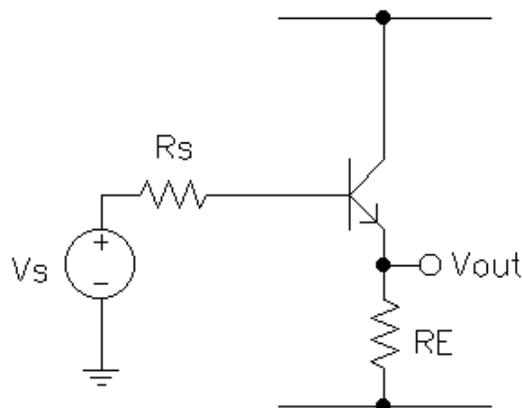
Abbiamo già avuto modo di vedere che questo circuito rappresenta un amplificatore di tensione reazionato mediante una connessione parallelo in uscita e serie in ingresso: infatti, la resistenza  $R_E$ , che costituisce, da sola, la rete di reazione, preleva la tensione di uscita  $v_O$  e la riporta così com'è in ingresso (cioè  $f=1$ ), in modo tale che la tensione pilota del transistor, a meno della  $R_S$ , sia  $v_{\pi}=v_S-v_O$ .
