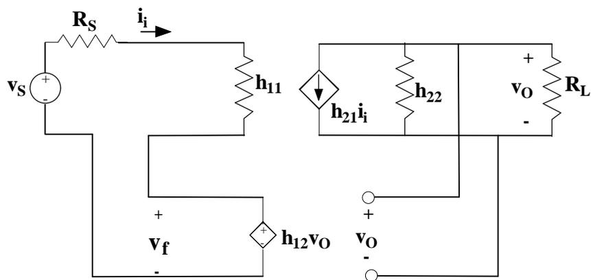
Come ampiamente visto in precedenza, questo schema, tramite la definizione dei singoli parametri, include gli effetti di carico e la bilateralità delle due reti, ma rappresenta queste stesse reti come unilaterali.
