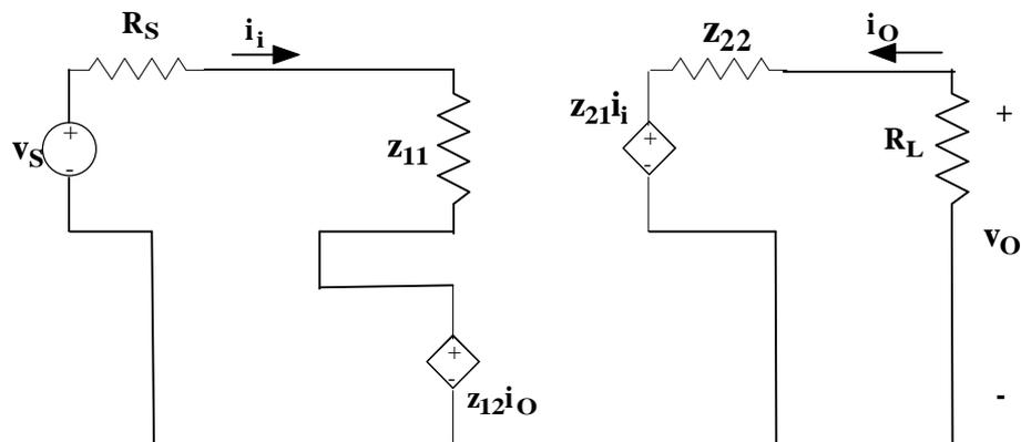
Dobbiamo a questo punto trovare l'espressione del guadagno di feedback  $A_f = i_o / v_s$  dell'amplificatore così rappresentato.
