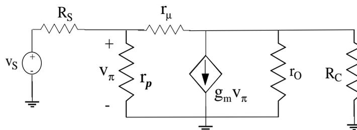
E' evidente, allora, che l'effetto della  $r_\mu$  può essere studiato in maniera identica a quella seguita per la  $R_F$ : per esempio, l'espressione del guadagno di tensione (ottenuta trascurando la  $r_o$ ) sarebbe
