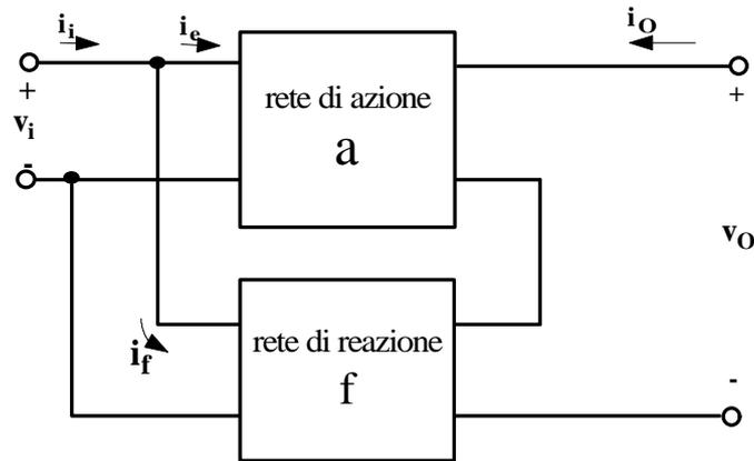
Sappiamo che questo tipo di connessione contribuisce a stabilizzare il guadagno in corrente dell'amplificatore: dato che  $i_e = i_i - i_f$ ,  $i_o = a i_e$  e  $i_f = f i_o$ , deduciamo infatti che
