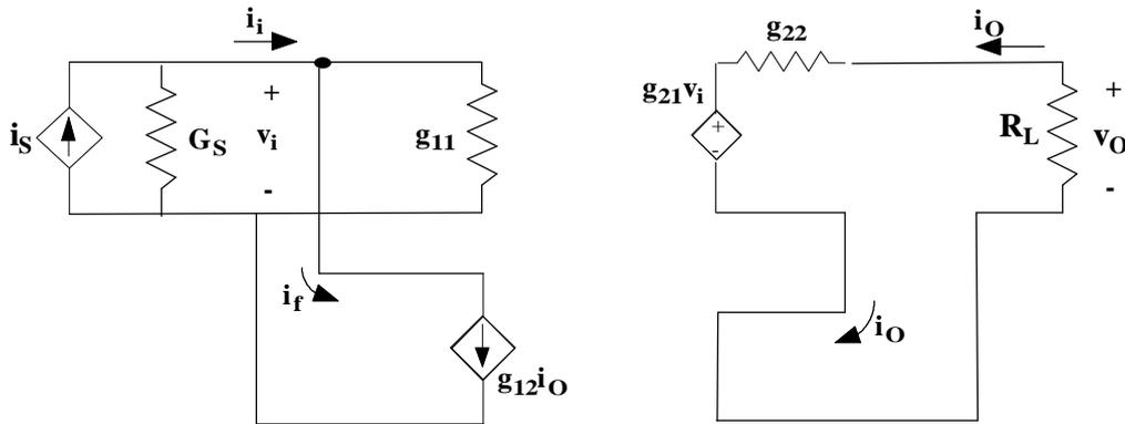
Dobbiamo a questo punto trovare l'espressione del guadagno di feedback  $A_f = i_o / i_s$  dell'amplificatore così rappresentato.
