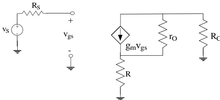
Ci conviene sostituire il parallelo tra il generatore pilotato e la  $r_o$  con il suo equivalente di Thevenin:
