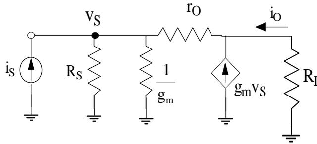
In questo caso, la reazione introdotta dalla sola  $r_o$  è diversa rispetto a prima: infatti, la  $r_o$  preleva la tensione di uscita (per cui abbiamo parallelo in uscita) e riporta in ingresso una corrente ad essa proporzionale (per cui abbiamo parallelo in ingresso). Quindi, *mentre il generatore pilotato effettuava una reazione parallelo-serie, la  $r_o$  esercita una reazione parallelo-parallelo*.
