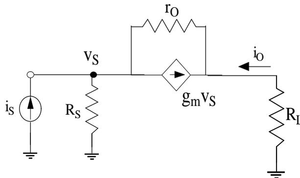
dove abbiamo posto  $v_{gs} = -v_s$  (tensione di source) in quanto il gate è a massa.
