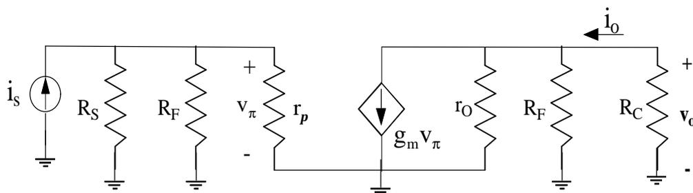
Possiamo dunque calcolare il guadagno della rete di azione con inclusi gli effetti di carico:
