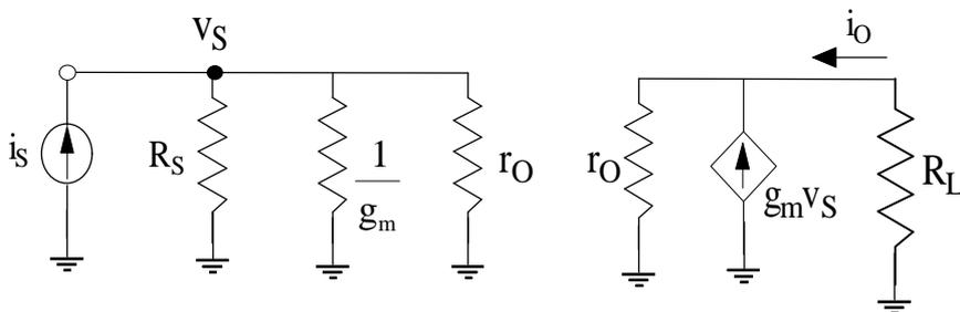
Per semplice comodità, conviene inoltre sostituire il parallelo tra il generatore pilotato e la  $r_o$  con il suo equivalente di Thevenin:
