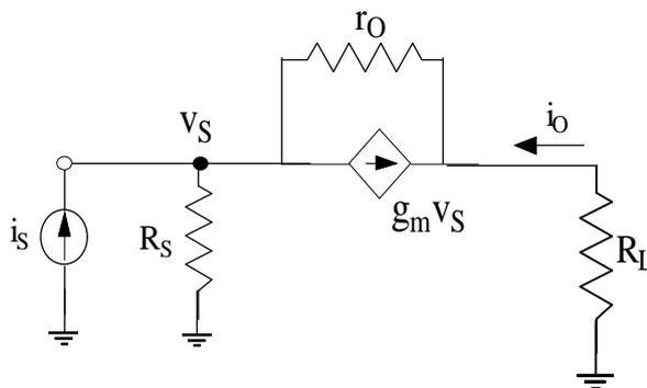
Conviene sostituire il parallelo tra il generatore pilotato e la  $r_o$  mediante il suo equivalente di Thevenin:
