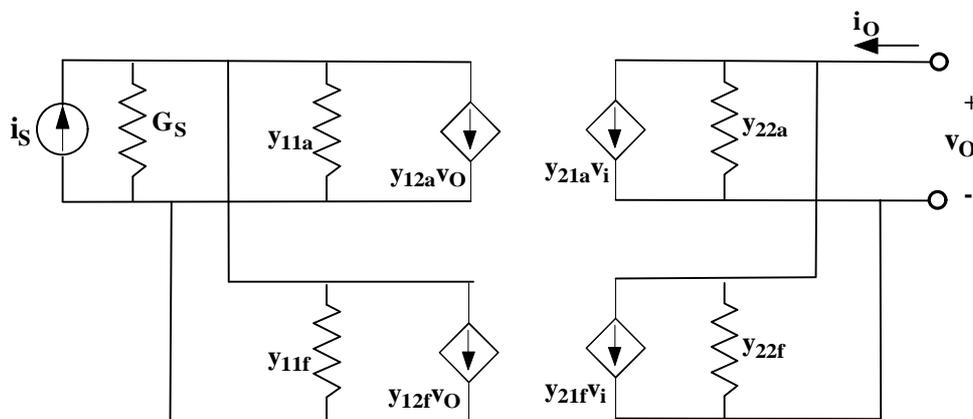
Così come abbiamo fatto nel caso della rappresentazione a parametri h di una connessione serie-parallelo, possiamo fare delle semplificazioni al fine di giungere ad uno schema ideale, in cui la rete di azione e quella di reazione risultino unilaterali e in cui la rete di azione comprenda gli effetti di carico su di essa esercitati dalla rete di reazione.
