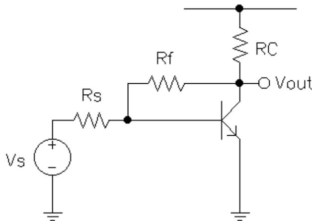
Per determinare gli effetti di carico in ingresso, dato che la connessione è di tipo parallelo, dobbiamo cortocircuitare l'uscita, in quanto questo annulla l'effetto di reazione, ma non annulla l'effetto di carico: se l'uscita è a massa, la  $R_F$  e la  $r_\pi$  sono in parallelo, per cui otteniamo la conduttanza
