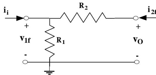
Determiniamo allora il modello a parametri h di questo circuito:
