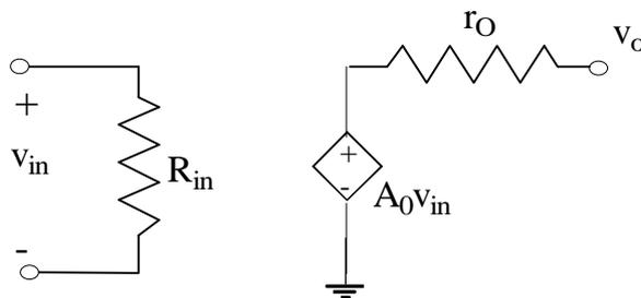
I valori dei parametri incrementali sono i seguenti: guadagno di tensione a vuoto  $A_0=10^4$ ; resistenza di uscita  $r_o=1\text{k}\Omega$ ; resistenza di ingresso  $R_{in}=100\text{k}\Omega$ .
