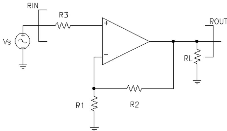
La scelta di queste due sezioni deriva sia dal fatto che è imposta dalla traccia sia anche dal fatto che, nel calcolo del guadagno di anello prima effettuato, abbiamo incluso sia la  $R_3$  sia la  $R_L$ , per cui, al fine di applicare le formule caratteristiche della connessione serie in ingresso e parallelo in uscita, dobbiamo necessariamente tener conto di tali resistenze: abbiamo dunque che
