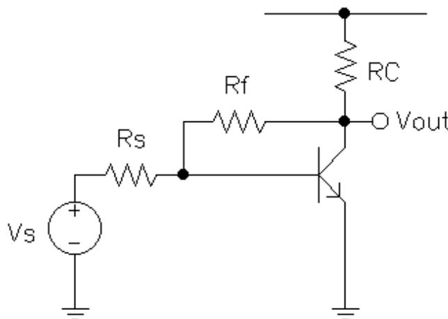
Si tratta di uno stadio invertitore a BJT, reazionato mediante una rete di reazione costituita semplicemente dalla resistenza  $R_F$ : quest'ultima preleva la tensione di uscita (parallelo in uscita) e riporta in ingresso una corrente (ad essa
