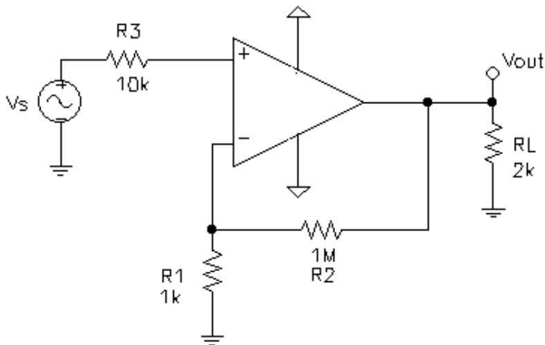
L'amplificatore inserito in questo circuito è un **amplificatore operazionale**. Senza scendere nei dettagli, che saranno approfonditi in un capitolo successivo, ci limitiamo a dire che si tratta tipicamente di un *amplificatore di tipo differenziale*, caratterizzato da un circuito incrementale fatto nel modo seguente:
