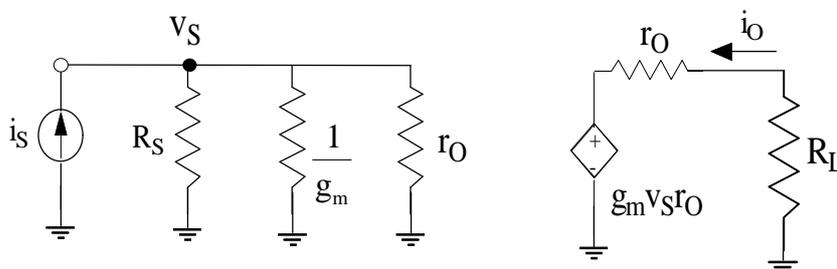
Su questo circuito possiamo calcolare il guadagno della rete di azione con gli effetti di carico: dato che
