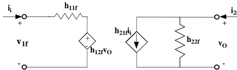
Possiamo allora tornare sul circuito di partenza e rappresentare la rete di reazione direttamente mediante questo circuito:
