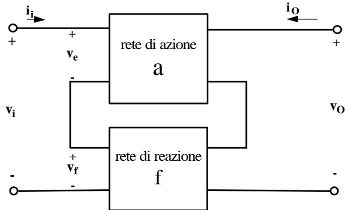
Sappiamo che *questo tipo di connessione contribuisce a stabilizzare il guadagno in transconduttanza dell'amplificatore*: dato che  $v_e = v_i - v_f$ ,  $i_o = a v_e$  e  $v_f = f i_o$ , deduciamo infatti che
