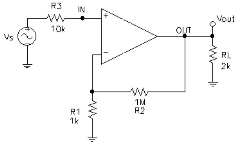
Una volta individuati tali morsetti, ci accorgiamo immediatamente che il circuito è reazionato, visto che la resistenza  $R_2$  riporta in ingresso una parte dell'uscita.
