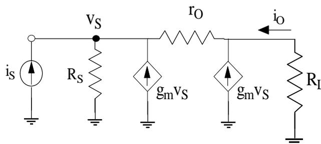
A questo punto, il generatore  $g_m v_s$  a sinistra è pilotato dalla stessa tensione ai suoi capi, per cui equivalente ad una resistenza  $1/g_m$ :
