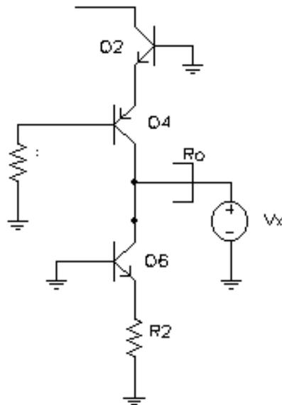
Possiamo ragionare direttamente su questo circuito: la resistenza vista guardando dentro l'emettitore di Q2 non è altro che la resistenza di ingresso di uno stadio base comune, ossia  $1/g_{m2}$ ; per quanto riguarda, invece, la resistenza  $R_{O1}$  vista dentro il collettore di Q4, possiamo trascurare la serie  $r_{\pi3}+r_{\pi1}$  (tra la base di Q4 e massa), per cui si tratta della resistenza di uscita di uno stadio invertitore con degenerazione  $1/g_{m2}$ , che quindi vale
