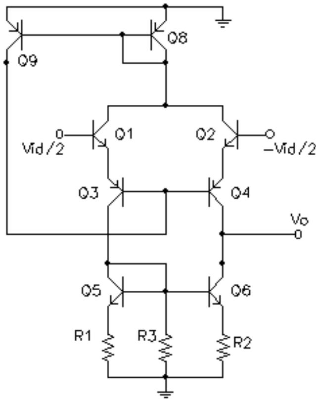
I parametri che ci interessano sono la resistenza di ingresso  $R_i$  di modo differenziale, la resistenza di uscita  $R_o$  e la transconduttanza  $G_M$ , con i quali potremo infatti modellare il circuito nel modo seguente:
