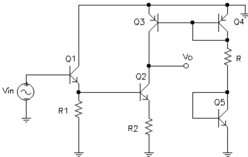
Possiamo inoltre sostituire tutto lo specchio di corrente con la sua resistenza di uscita, che sappiamo essere quella di  $Q_3$ :
