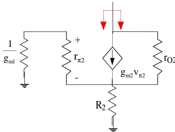
Dato che  $R_2=100\Omega$ , possiamo sicuramente ritenerla prevalente nel parallelo con  $r_{\pi 2} + \frac{1}{g_{m1}}$ ; per far questo, però, dobbiamo prima trovare una espressione per  $v_{\pi 2}$ :
