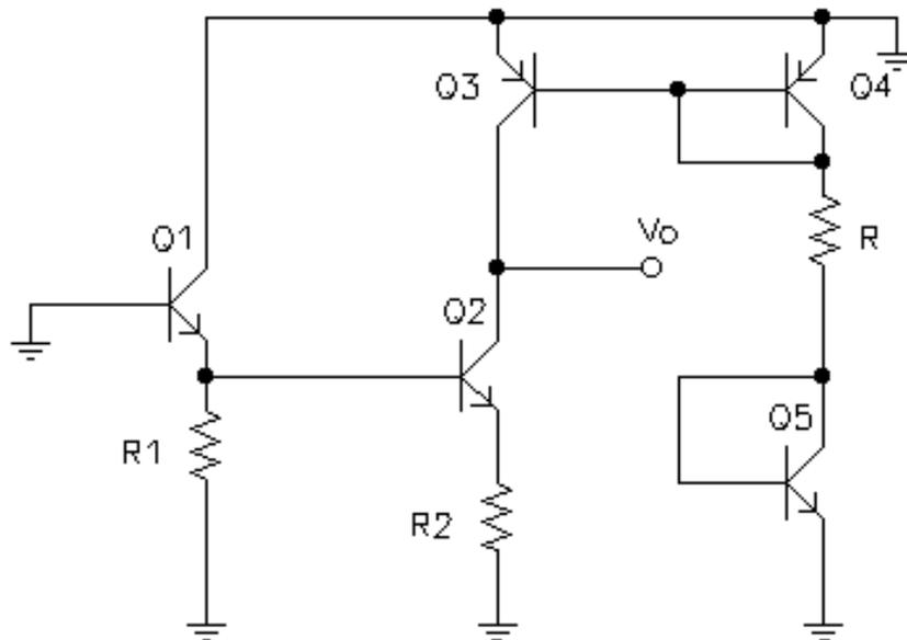
La resistenza di uscita non è altro che il parallelo tra la resistenza vista guardando dentro il collettore di Q3 e quella vista guardando il collettore di Q2.
