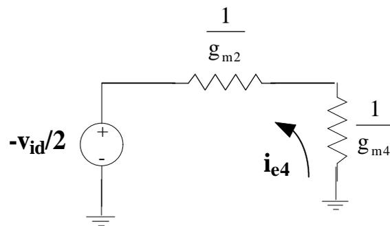
L'analisi di questo circuito è immediata: la corrente di emettitore di Q4, approssimativamente coincidente con quella di collettore, è
