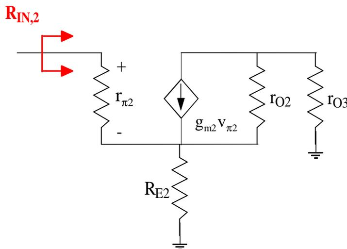
Per effettuare questo calcolo, conviene sostituire il parallelo tra il generatore pilotato e la  $r_{O2}$  con il suo equivalente di Thevenin<sup>2</sup>:
