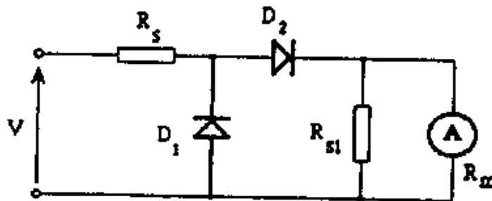
Rispetto al circuito precedente, abbiamo aggiunto un diodo (indicato con  $D_1$ ) ed un resistore (indicato con  $R_{S1}$ ).
