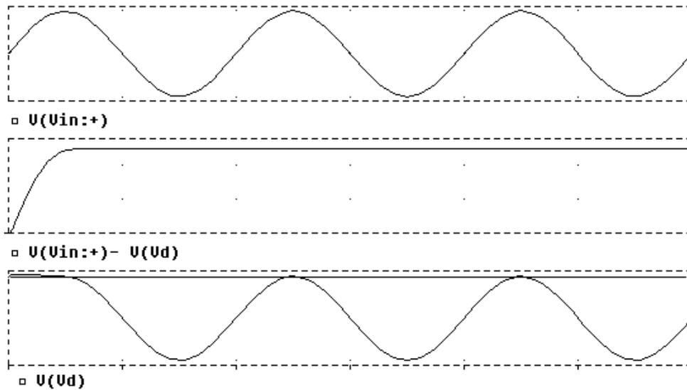
Inizialmente, con la tensione applicata positiva, il diodo conduce e si comporta perciò da cortocircuito, facendo sì che la tensione ai capi del condensatore segua perfettamente l'ingresso.
