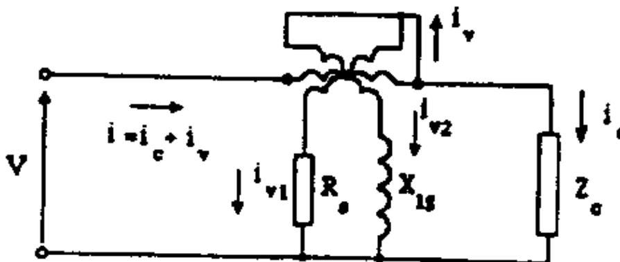
La bobina amperometrica dello strumento è attraversata dalla corrente  $i = i_C + i_V$ , somma della corrente di carico e della corrente nel circuito voltmetrico; quest'ultimo è costituito da due bobine mobili: la prima ha in serie il resistore  $R_S$  (attraversato da  $i_{V1}$ ) mentre l'altra ha in serie l'induttore  $L_S$
