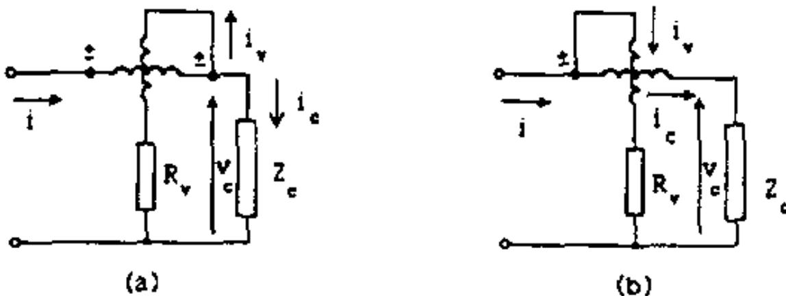
La figura (a) mostra la cosiddetta **connessione a valle**, in cui il resistore addizionale  $R_V$  è connesso a valle della **bobina amperometrica**. La figura (b) mostra la cosiddetta **connessione a monte**, in cui  $R_V$  è connesso a monte della suddetta bobina e quindi questa è in serie al carico.
