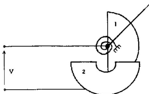
Abbiamo in questo caso due piatti piani a forma di semicerchio, di cui il numero 1 mobile e libero di ruotare nella zona sottostante quello fisso (il numero 2). Il moto dell'indice è solidale con il piatto mobile ed è contrastato dalla solita molla antagonista.
