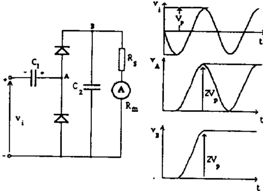
Questo circuito prende il nome di **moltiplicatore di tensione**. Per analizzarne il funzionamento, consideriamo sempre una tensione in ingresso di tipo sinusoidale e inoltre supponiamo che i due condensatori (con  $C_1 \gg C_2$ ) siano inizialmente scarichi.
