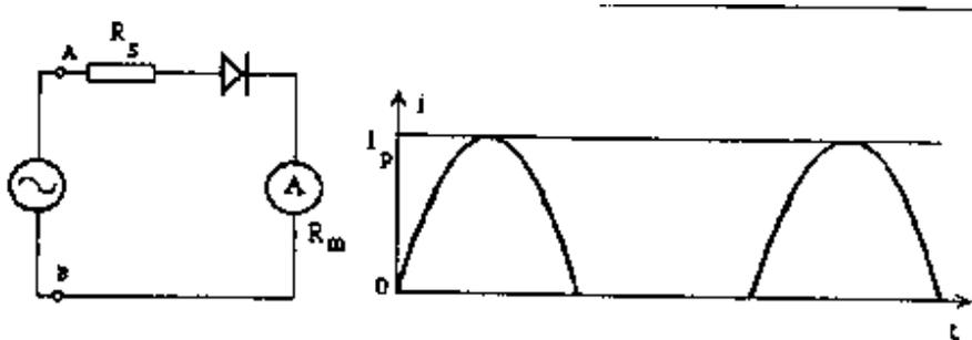
Per semplicità, supponiamo che il segnale da misurare, applicato ai morsetti A e B dello strumento, sia una tensione puramente sinusoidale con ampiezza (o valore di picco) pari a  $V_P$ :
