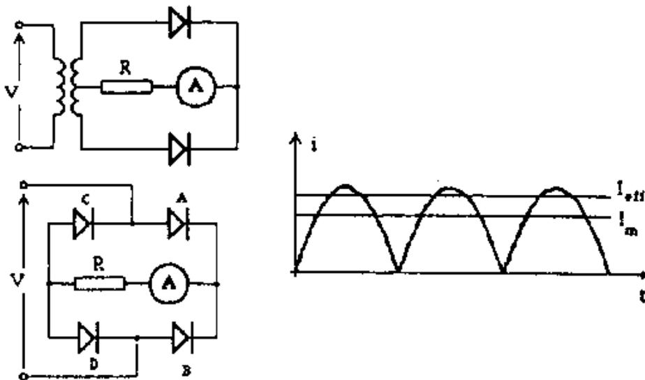
Il circuito più in alto sfrutta un **trasformatore di tensione a presa centrale**. Il problema principale di questo circuito è nei limiti di frequenza, imposti proprio dal trasformatore. Di gran lunga più utilizzato è invece l'altro circuito, che sfrutta un classico **ponte di Graetz** a diodi. Il funzionamento di tale circuito è semplice, nell'ipotesi di ingresso puramente sinusoidale:
