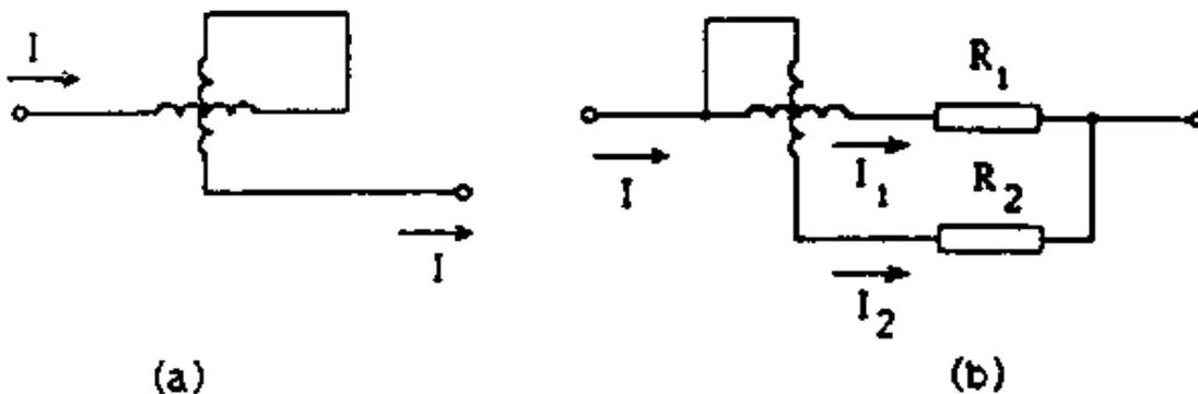
Nella configurazione (a), le due bobine sono connesse in **serie**, in quanto sono attraversate dalla stessa corrente (per cui  $I_1=I_2=I$ ). La deflessione angolare è data allora da
