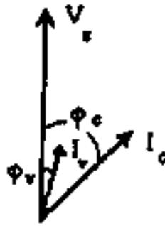
dove ovviamente  $\varphi_C = \arctg \frac{X_C}{R_C}$  è il fattore di potenza del carico.
