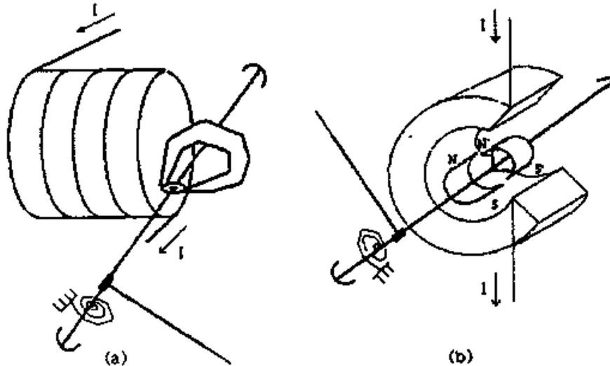
Nella figura (a) è riportata la realizzazione **ad attrazione** (o anche *a succhiamento*), mentre nella figura (b) è riportata la realizzazione **a repulsione**. In entrambi i casi, notiamo la presenza del solito indice solidale con l'equipaggio mobile e delle solite molle antagoniste. Per quanto riguarda, invece, lo smorzamento, è ottenuto per via elettromagnetica.
