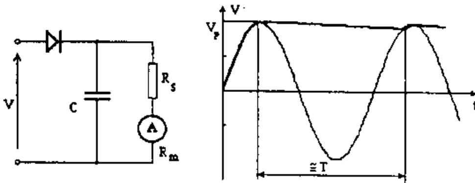
Se ignoriamo per un attimo la presenza dell'amperometro, notiamo che si tratta del classico **circuito di mantenimento** (o *alimentatore o demodulatore ad involuppo*), in cui il diodo fa da raddrizzatore e il parallelo RC fa da cella di mantenimento. Con riferimento ad una sinusoide (come illustrato in figura), il funzionamento è il seguente:
