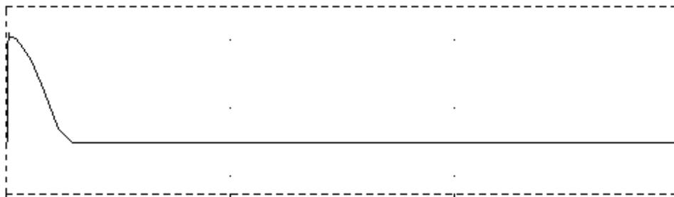
Come si nota, la corrente scorre solo inizialmente, quanto basta per caricare il condensatore alla tensione  $V_P$ , dopo di che il diodo è perennemente interdetto.
