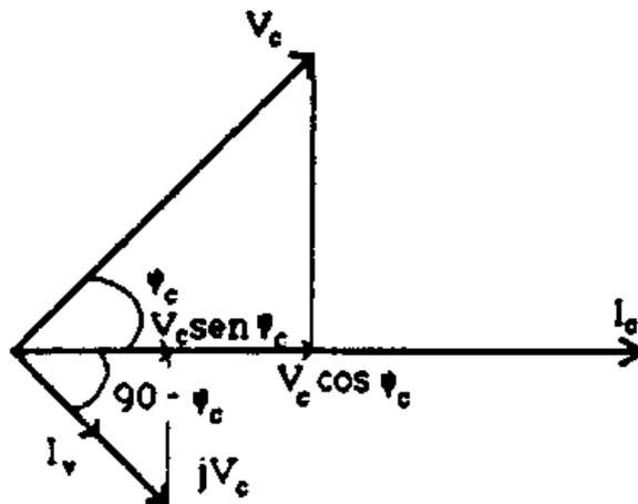
In questo diagramma,  $V_C$  ed  $I_C$  sono rispettivamente tensione e corrente sul carico, sfasate di un angolo  $\varphi_C$  dovuto alla presenza, nel suddetto carico, di una parte reattiva  $X_C$  oltre a quella resistiva  $R_C$ . Nel paragrafo precedente, abbiamo visto che la coppia motrice media presente nello strumento, sia per la connessione a valle sia per quella a monte, vale
