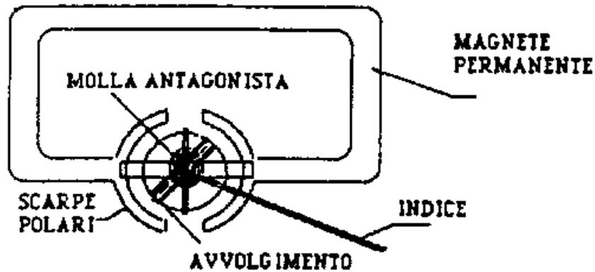
Il **magnete permanente** ha la forma di un ferro di cavallo e termina con due espansioni polari di ferro dolce (dette **scarpe polari**); nel progetto dello strumento si tende, una volta fissato lo spazio da occupare, a rendere più grande possibile il magnete, in modo da ottenere, nel traferro, il massimo flusso possibile e quindi la massima sensibilità.
