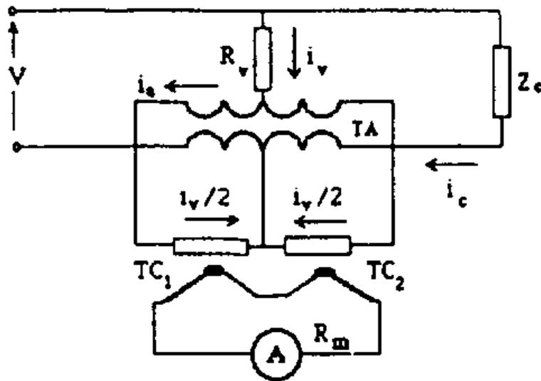
Questo è un **convertitore termico di potenza**: è costituito da due *termocoppie* (TC1 e TC2) collegate a due *riscaldatori*; questi ultimi sono inseriti nel circuito di cui si vuol misurare la potenza e a tale scopo viene usato un *trasformatore di corrente* (TA) a presa centrale (sia sul prima sia sul secondario) ed un *divisore resistivo*  $R_v$ .
