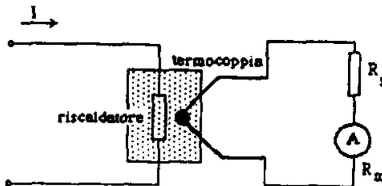
Il giunto caldo della termocoppia (che è un sensore di temperatura) è soggetto all'azione termica di un riscaldatore, che è attraversato dalla corrente elettrica  $I$  da misurare. L'effetto termico sul giunto caldo determina l'insorgere di una forza elettromotrice ai capi dei morsetti della termocoppia;
