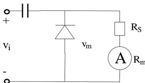
Supponiamo che il condensatore sia inizialmente scarico (per esempio, supponiamo che il circuito sia stato lasciato a se stante da tempo immemore, con  $v_{in}(t)=0$  per  $t<0$ ). All'istante  $t=0$ , il generatore
