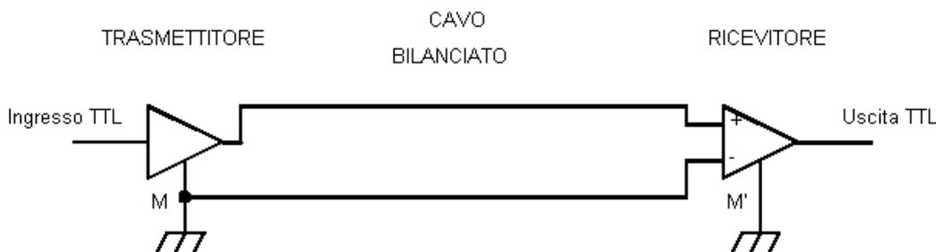
Il trasmettitore deve avere impedenza di uscita inferiore a  $50\Omega$  e deve produrre sul cavo di collegamento una d.d.p. compresa tra 4V e 6V. La tensione di uscita, rispetto a massa, deve essere negativa nello stato logico 1 (mark) e positiva nello stato logico 0 (space). La corrente d'uscita di cortocircuito deve essere inferiore a 150mA.
