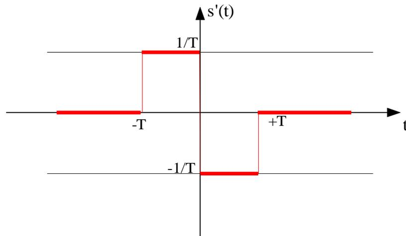
Anche questo segnale ha una espressione complessa. Proviamo allora con l'ulteriore segnale derivato:
