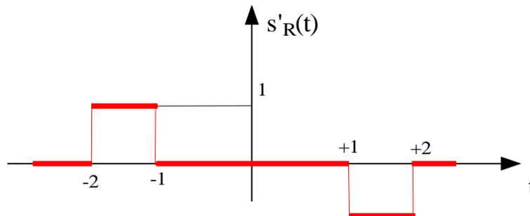
Anche la trasformata di questo segnale non è facile da calcolare; proviamo allora a vedere se è più facile il calcolo di quella dell'ulteriore segnale derivato, ossia  $s_R''(t)$ . Dobbiamo perciò determinare come è fatto questo segnale. Verifichiamo che esso è fatto nel modo seguente:
