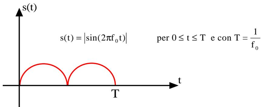
Il segnale  $s(t)$  è dunque solo la parte positiva e compresa in  $[0, T]$  della funzione Seno con periodo appunto  $T$ . Vogliamo la trasformata di Fourier di  $s(t)$ .
