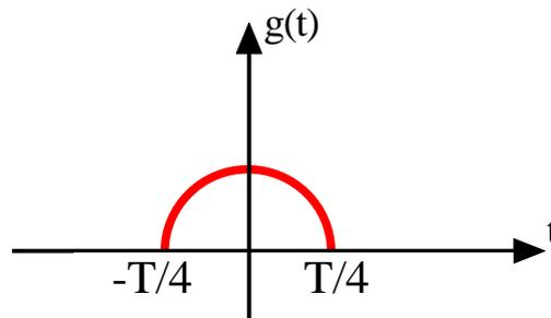
Allora, possiamo trovare la trasformata di  $g(t)$ ; da essa risalire a quella di  $x(t)$  mediante il teorema di traslazione nel tempo e, ancora mediante questo teorema, possiamo infine trovare la trasformata di  $s(t)$ .
