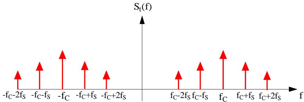
Si nota che il valore massimo si ha in corrispondenza della frequenza  $f_c$  della portante (e ovviamente del suo valore simmetrico  $-f_c$ ), mentre, allontanandosi via via de essa, l'area degli impulsi decresce.
