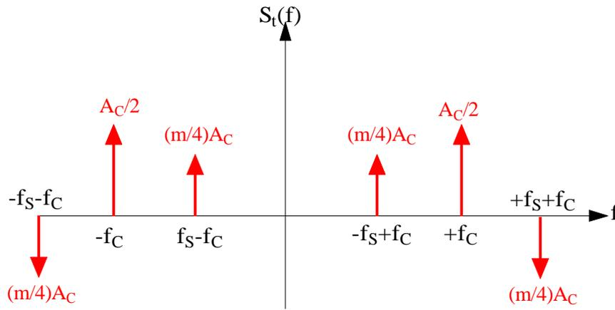
Ciò che si deduce è dunque che la banda del segnale modulato è  $f_s + f_c$ , ossia corrisponde alla somma della banda (che poi è la frequenza) della portante e del segnale modulante. Quindi, i valori non nulli dello spettro si hanno nei due intervalli  $[-f_s - f_c, f_s - f_c]$  e  $[-f_s + f_c, f_s + f_c]$ , mentre al di fuori di tali intervalli si hanno solo valori nulli.
