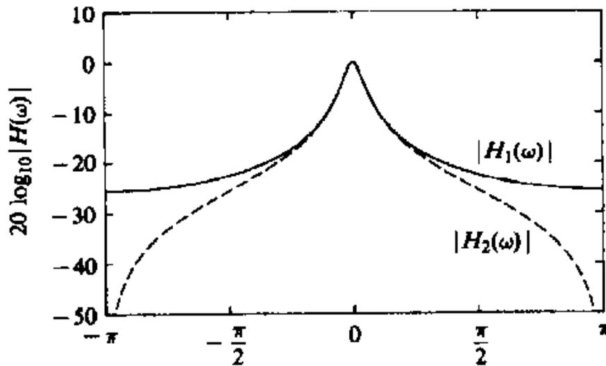
Si nota subito che l'attenuazione di  $H_2(\omega)$  è decisamente più elevata, alle alte frequenze, rispetto ad  $H_1(\omega)$ , mentre invece l'andamento delle due funzioni alle basse frequenze è praticamente lo stesso.
