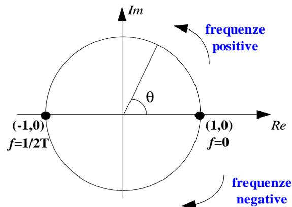
Ogni punto è individuato da un vettore, di modulo  $r$  e fase  $\theta$  (rispetto all'asse reale positivo). Se consideriamo, in particolare, punti sul **cerchio di raggio unitario**, allora  $r=1$ , per cui l'unico parametro identificativo diventa l'angolo  $\theta$ . Con riferimento allora a tali punti, abbiamo quanto segue:
