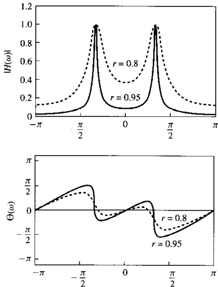
Si nota subito, nell'andamento del modulo, che il diverso valore di  $r$  non produce un valore diverso del picco di risonanza, ma determina in modo leggermente complesso l'andamento generale della  $H(\omega)$ : come verificheremo più avanti, un valore di  $r$  maggiore (cioè una maggiore vicinanza dei poli al cerchio unitario) determina maggiore selettività da parte del filtro.
