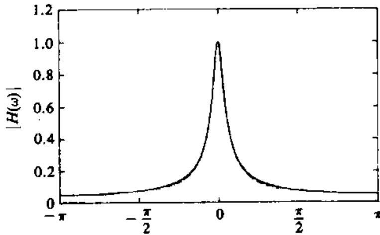
Una simile funzione di trasferimento si ottiene con la seguente funzione di sistema:
