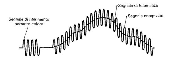
Questi cosiddetti **burst** inviati negli intervalli di linea sono sufficienti per la generazione, nel ricevitore, di una oscillazione locale in fase con la sottoportante coseno necessaria alla demodulazione coerente.
