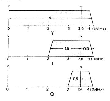
Lo spettro più in alto (Y) è quello del segnale di luminanza: vengono evidenziate la portante video (indicata con v e situata a  $\cong 0$ Hz) e la sottoportante colore (indicata con s e posta, come detto prima, a 3.58 MHz).
