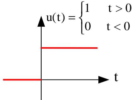
Esso presenta evidentemente una discontinuità nel punto  $t=0$ , in quanto per  $t=0^-$  vale 0 e per  $t=0^+$  vale 1. Per convenzione, si pone allora  $u(t=0) = \frac{1}{2}$ , con l'accortezza, però, di ricordare che comunque c'è la discontinuità.
