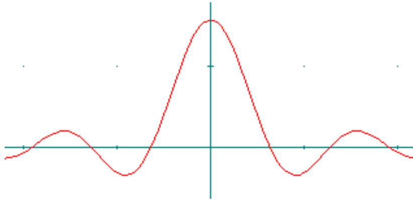
I punti di intersezione con l'asse delle ascisse (cioè l'asse t) sono ..-3,-2,-1,+1,+2,+3,...
